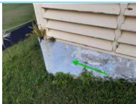
Matériaux : M016 Prélèvement : P016 Description : P016 - Enduit mur terrasse messe Localisation : Bâtiment 3 - Pignon Sud Résultat : Absence d'amiante
