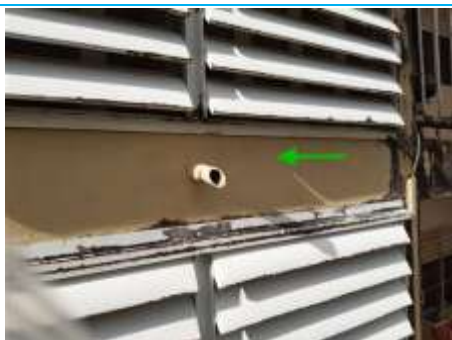
Matériaux : M005 Prélèvement : P005 Description : P005 - Enduit poutre persiennes Localisation : Bâtiment 3 - Façade Est Résultat : Absence d'amiante
